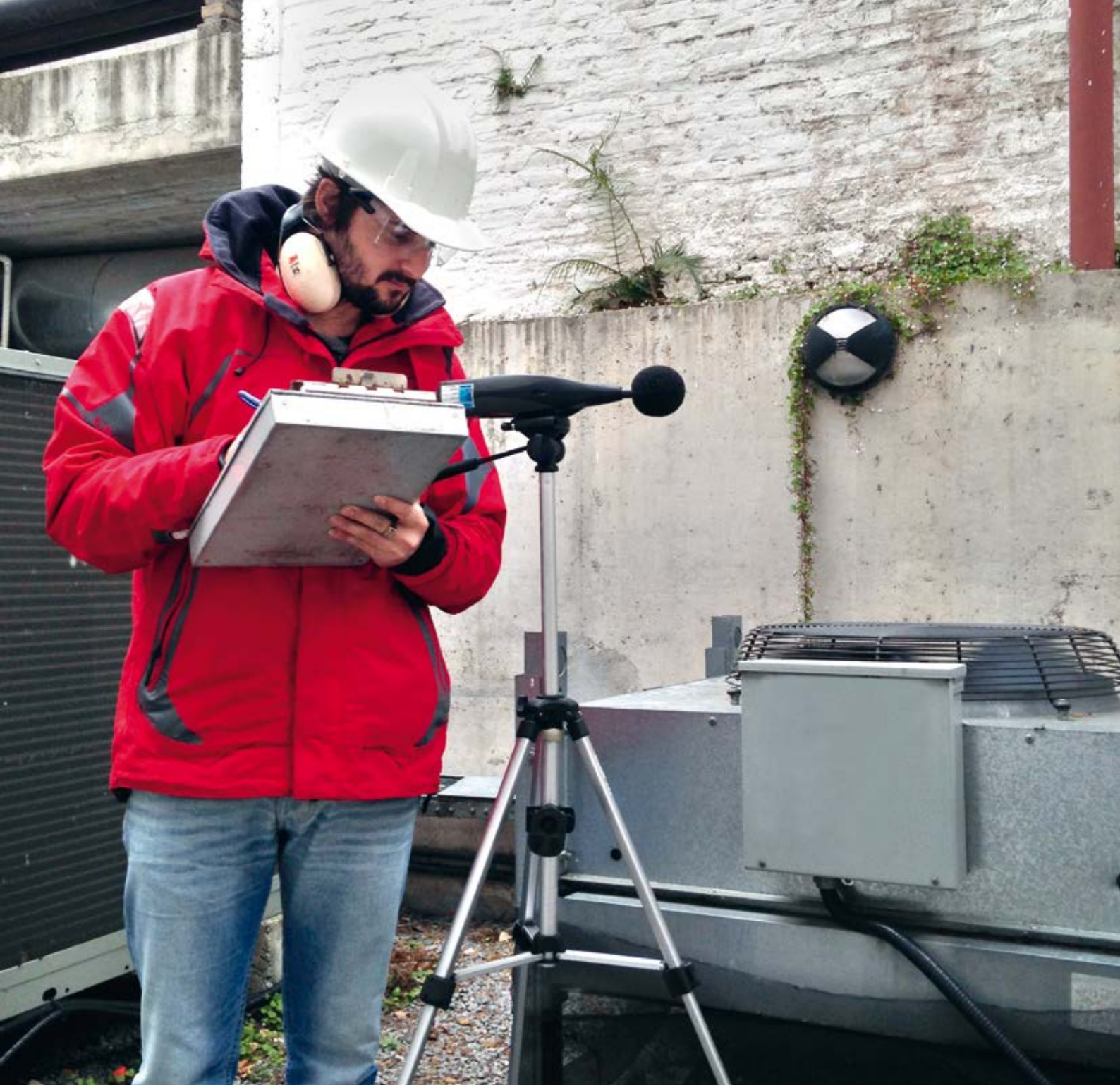
Un sonómetro es el instrumento utilizado para medir el nivel de presión sonora y controlar los parámetros de contaminación. Para asegurar que sus mediciones sean precisas se debe calibrar anualmente. Foto: cedida por el LATU.
